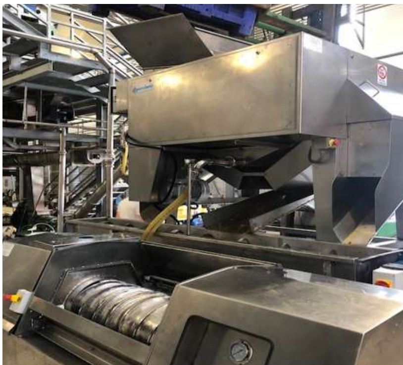
Fig. 12. macchina estrattrice di succo di fichidindia
