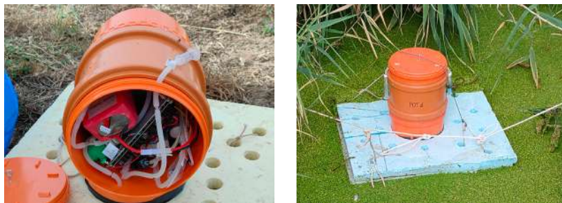
Fig. 10: Camera chiusa dinamica, installata su una struttura galleggiante, utilizzata per il rilievo dei flussi di anidride carbonica dai bacini di lagunaggio e dalla vasca di fitodepurazione a flusso superficiale dell'ORTOGEL.
