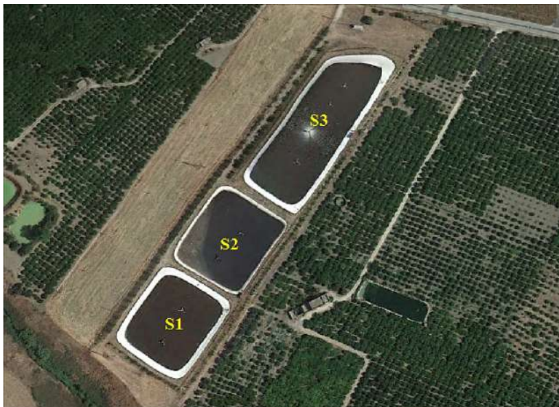
Fig. 1. Sistema di lagunaggio a servizio dell'azienda ORTOGEL s.p.a. (Caltagirone, Catania) costituito da 3 stagni aerati (S1, S2, S3)
